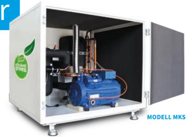
Die Gaugele Kompakt-Chiller der Baureihe MKL und MKS definieren Kältesätze neu: Wesentlicher Bestandteil ist ein sogenannter Multichannel-Plattenwärmetauscher, der gleichzeitig als Verdampfer, Verflüssiger und innerer Wärmetauscher dient und so drei herkömmliche Wärmetauscher ersetzt. Er ermöglicht es als bislang einziger Plattenwärmetauscher, mehrere Medien in einem Wärmetauscherkanal zu führen.
